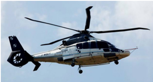
Pales Blue Edge développées par l'ONERA utilisées par Airbus pour l'hélicoptère H 160
