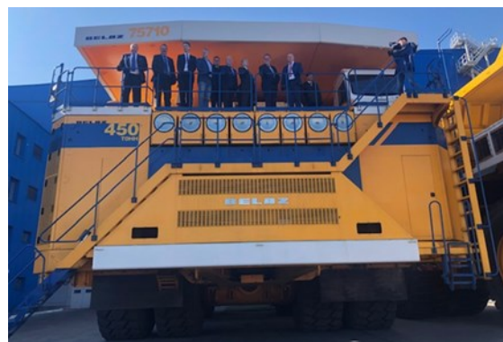
La délégation sur le BelAZ 75710, plus grand camion au monde (20 m de long, 8 m de haut et une capacité de transport de 450 tonnes de matériaux)
